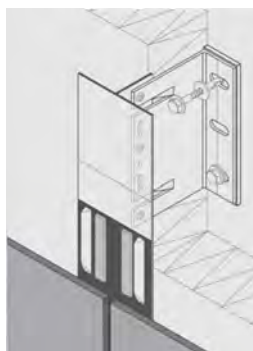
شکل ۷-۳۹- سیستم نصب پنهان با چسب صنعتی
