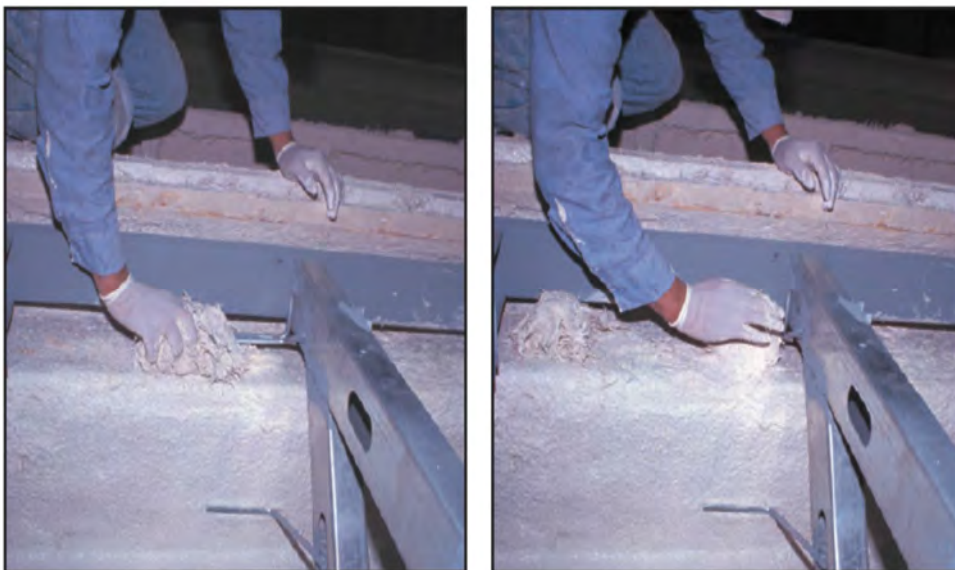
شکل ۶-۴۳- ساختن لایه‌های پیوندی
