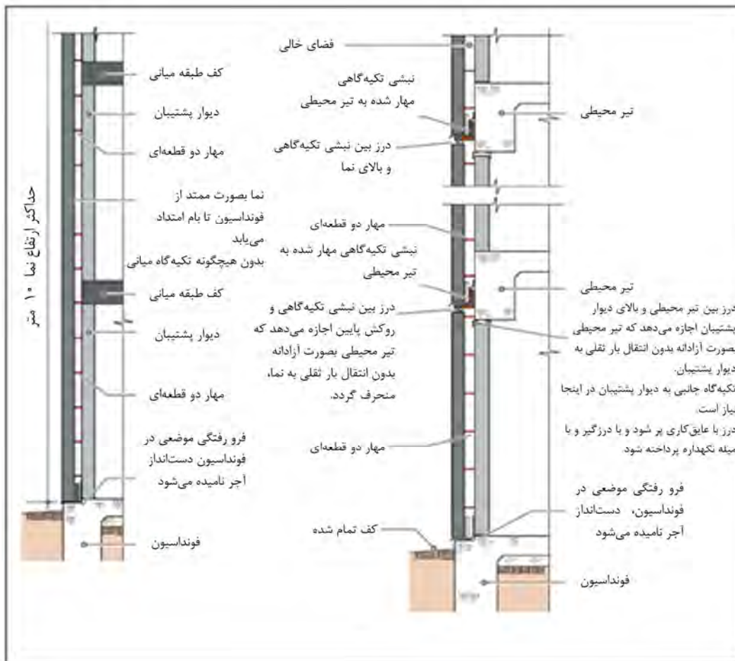
شکل ۵-۹- تکیه‌گاه‌ها جهت تحمل بار ثقیلی نما
