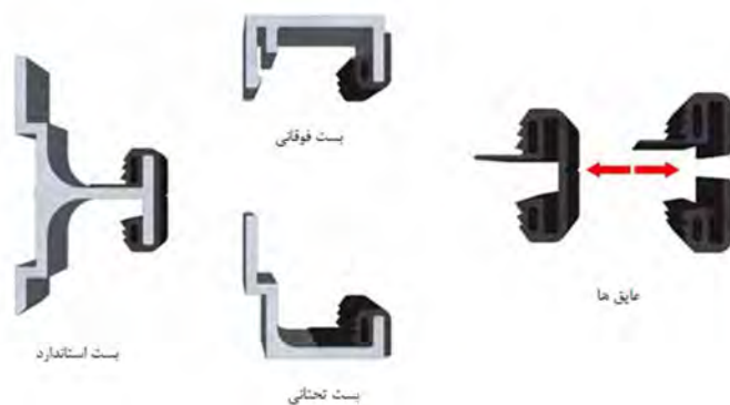
شکل ۷-۱۱- نصب درزپوش بر روی بست‌ها
