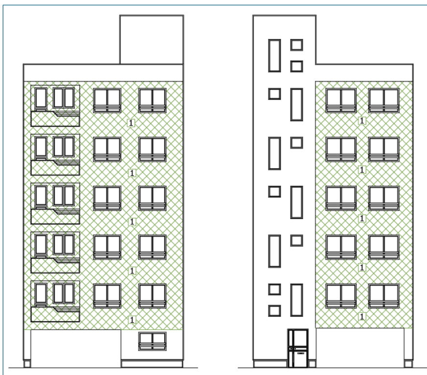
محل عایقکاری حرارتی در نمای شمالی و نمای جنوبی
