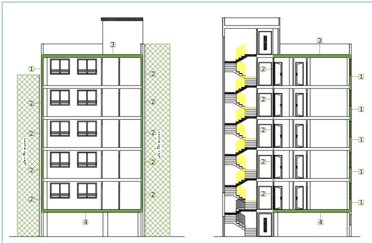
محل عایقکاری حرارتی در برش الف-الف و برش ب-ب
